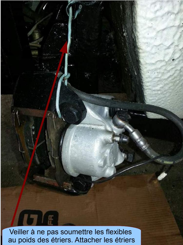
Veiller à ne pas soumettre les flexibles au poids des étriers. Attacher les étriers au châssis à l'aide d'un fil électrique.
